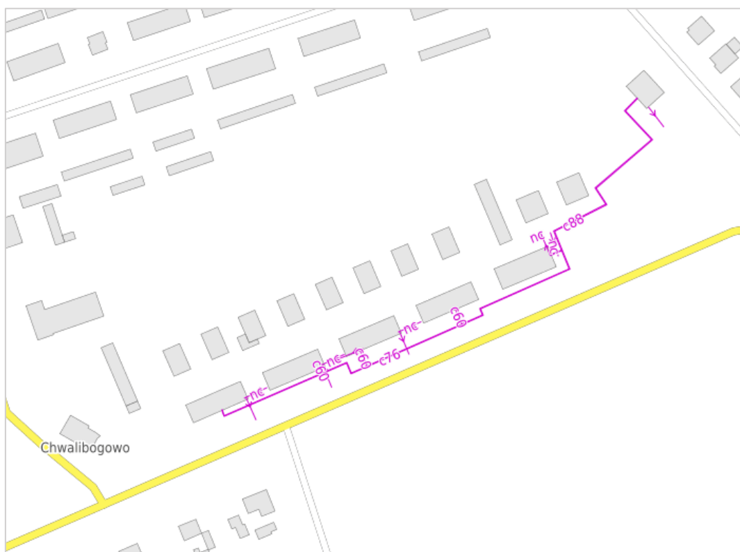
Rysunek 8. Sieć ciepłownicza Ciepłowni Chwalibogowo 31A
