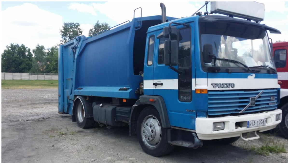
Samochód ciężarowy marki Volvo FL614 z zabudową śmieciarki NORBA RL 200
