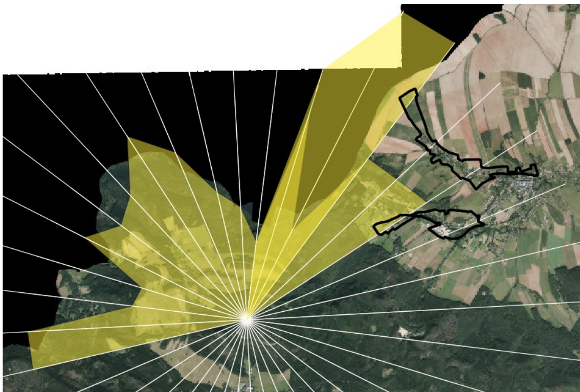
Rysunek 21. Żółta strefa - zasięg widoczności częściowej. Analizę przeprowadzono w promieniu 5,5 km z miejsca widokowego na Szczelińcu Wielkim [źródło: opracowanie własne na podstawie Numerycznego Modelu Terenu Geoportal]
