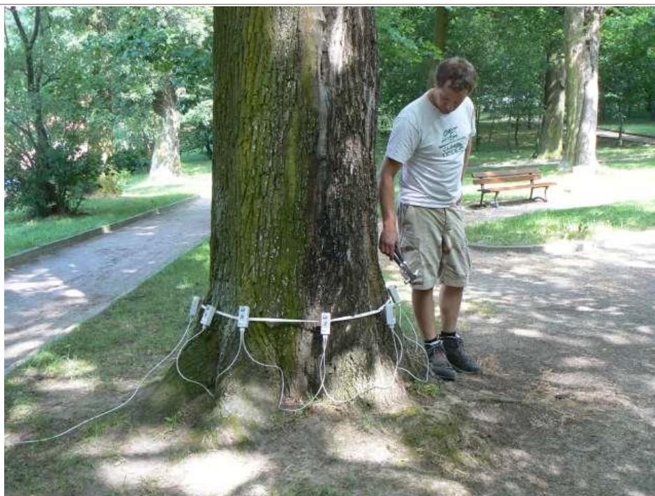
Ryc. 17 Przeprowadzanie badania pnia na drzewie nr 4 (klon pospolity) na wysokości 45 cm
