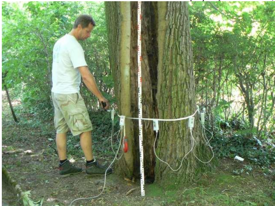
Ryc. 12 Przeprowadzanie badania pnia na drzewie nr 2 (klon pospolity 'Schwedlera') na wysokości 70 cm
