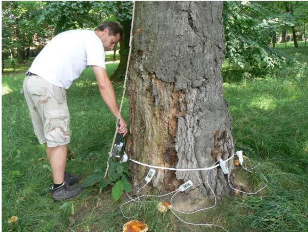
Ryc. 6 Przeprowadzanie badania pnia na wysokości 20 cm (I pomiar)
