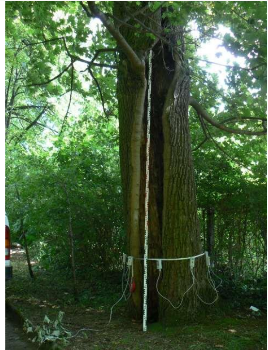
Ryc. 11 Wielkość ubytku węgłnego oraz czujniki impulsowe zamontowane na drzewie nr 2 (klon pospolity 'Schwedlera')
