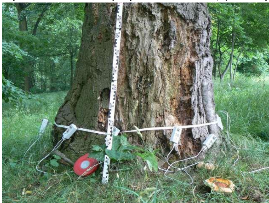
Ryc. 5 Czujniki impulsowe zamontowane na drzewie nr 1 – dąb czerwony (I pomiar)
