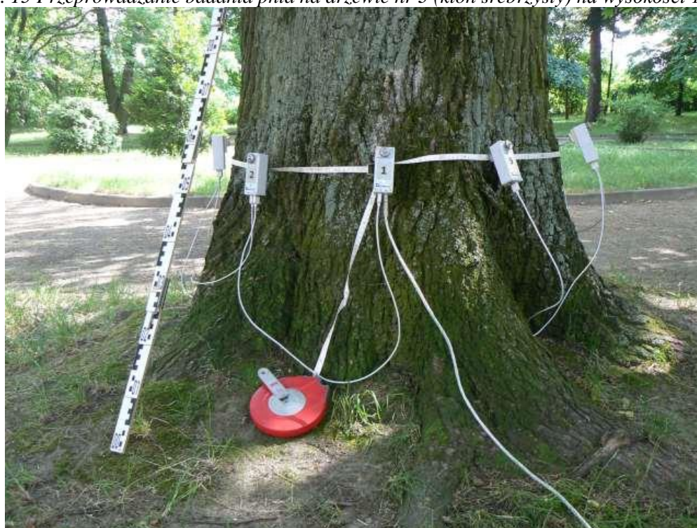
Ryc. 16 Czujniki impulsowe zamontowane na drzewie nr 4 (klon pospolity) wysokości 45 cm
