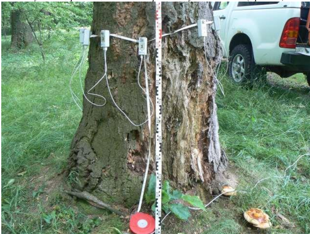
Ryc. 7 Czujniki impulsowe zamontowane na drzewie nr 1 (dąb czerwony) wysokości 110 cm (II pomiar).
