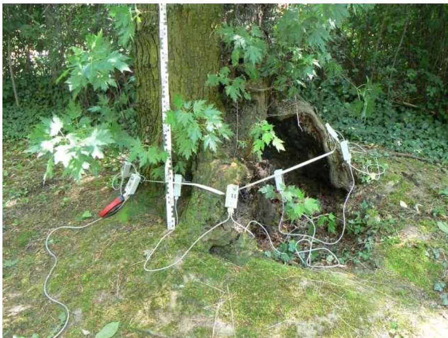
Ryc. 14 Czujniki impulsowe zamontowane na drzewie nr 3 (klon srebrzysty) wysokości 10 cm
