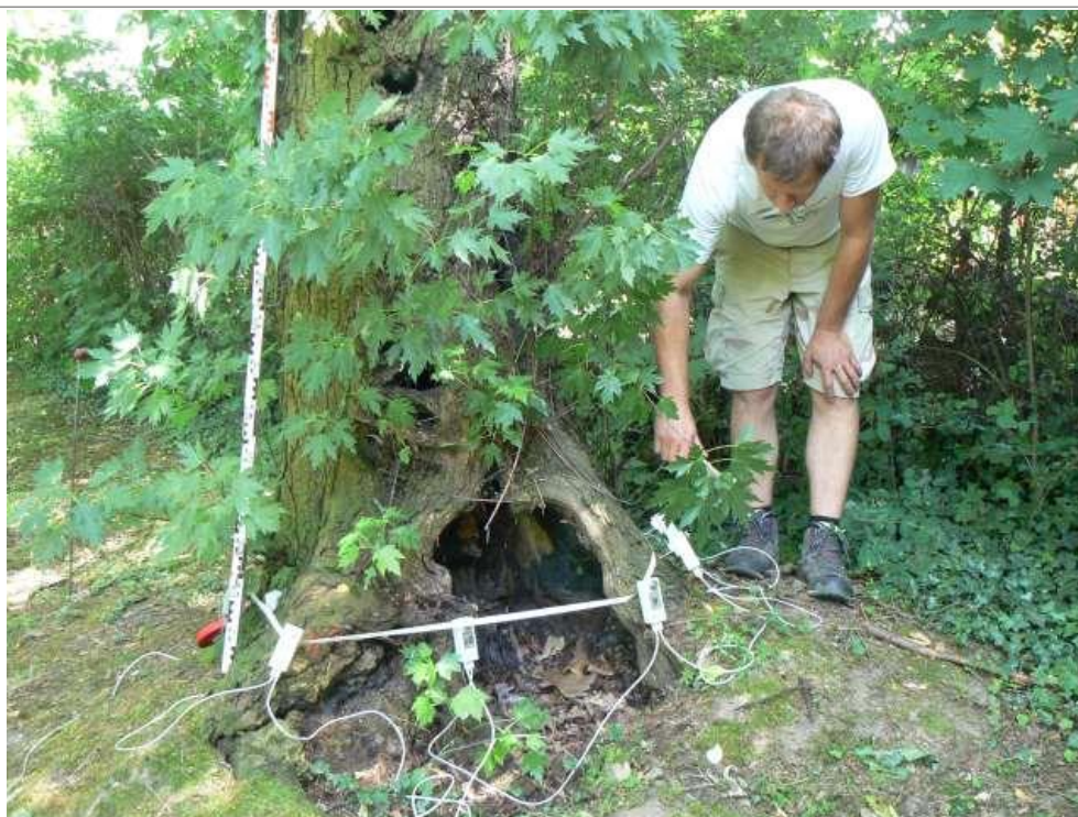
Ryc. 15 Przeprowadzanie badania pnia na drzewie nr 3 (klon srebrzysty) na wysokości 10 cm
