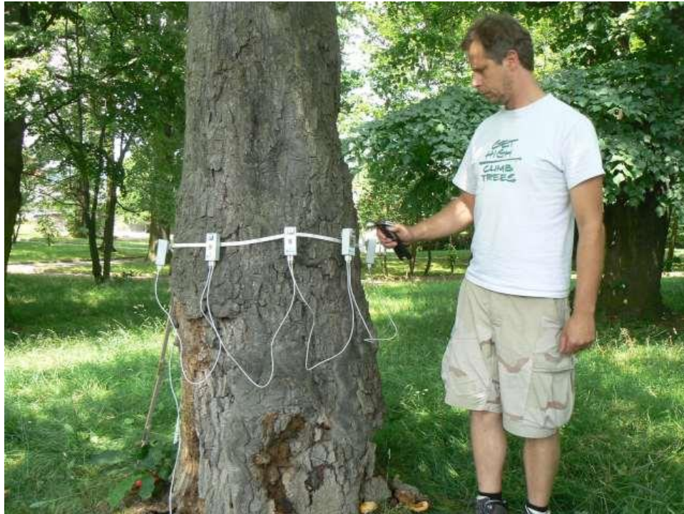
Ryc. 8 Przeprowadzanie badania pnia na wysokości 110 cm (II pomiar)
