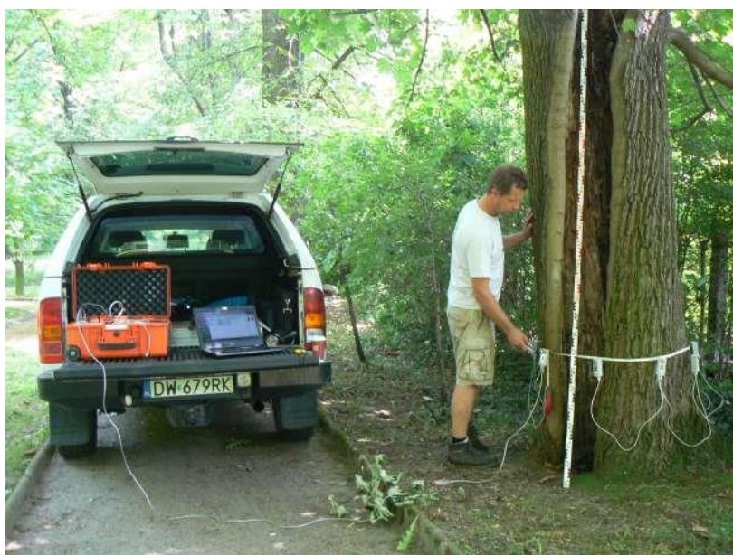
Ryc. 2 Stanowisko pomiarowe Arbotom™ z modulem rejestrującym
