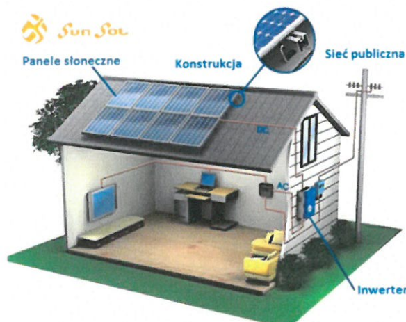
Rys 3. Schemat instalacji fotowoltaicznej.
