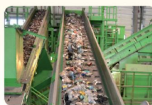
Linia sortownicza odpadów w sp. z o.o Eko-Dolina.
