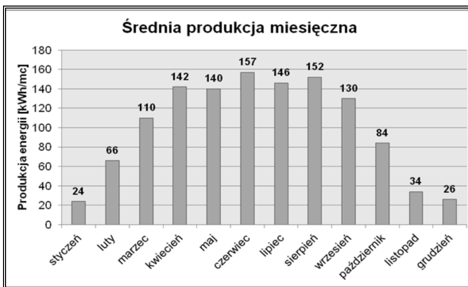
Wykres 8. Produkcja energii elektrycznej przez panele fotowoltaiczne
