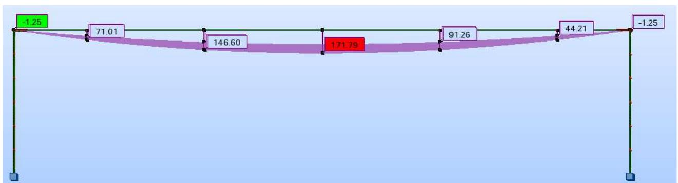
Rys. 5. Obwiednia momentów w dźwigarach dla obciążenia mokrym betonem – faza I [kNm]
