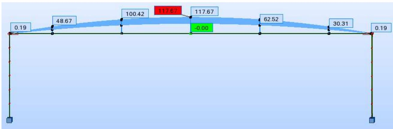
Rys. 9. Obwiednia naprężeń zastępczych maksymalnych występujących w konstrukcji dla obciążenia mokrym betonem [MPa]
