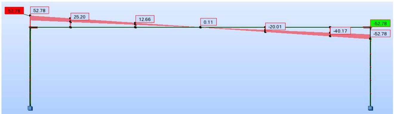
Rys. 6. Obwiednia sił poprzecznych w dźwigarach dla obciążenia mokrym betonem – faza I [kN]
